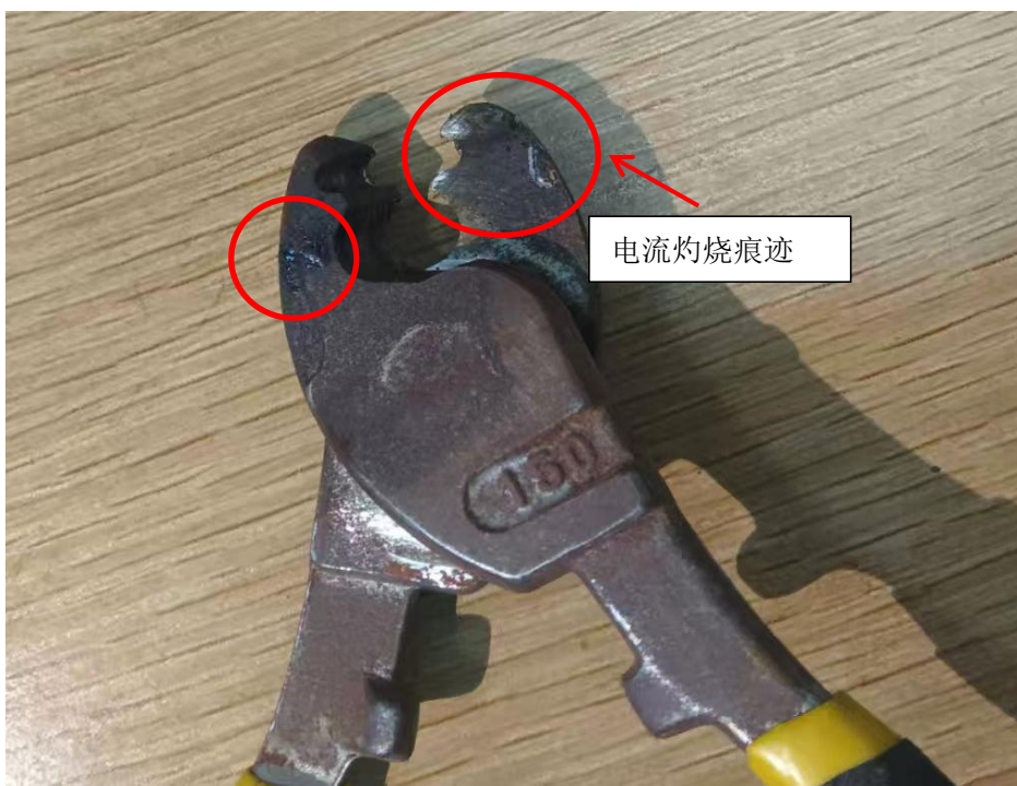
图4 事发剥线钳多处被灼烧痕迹
