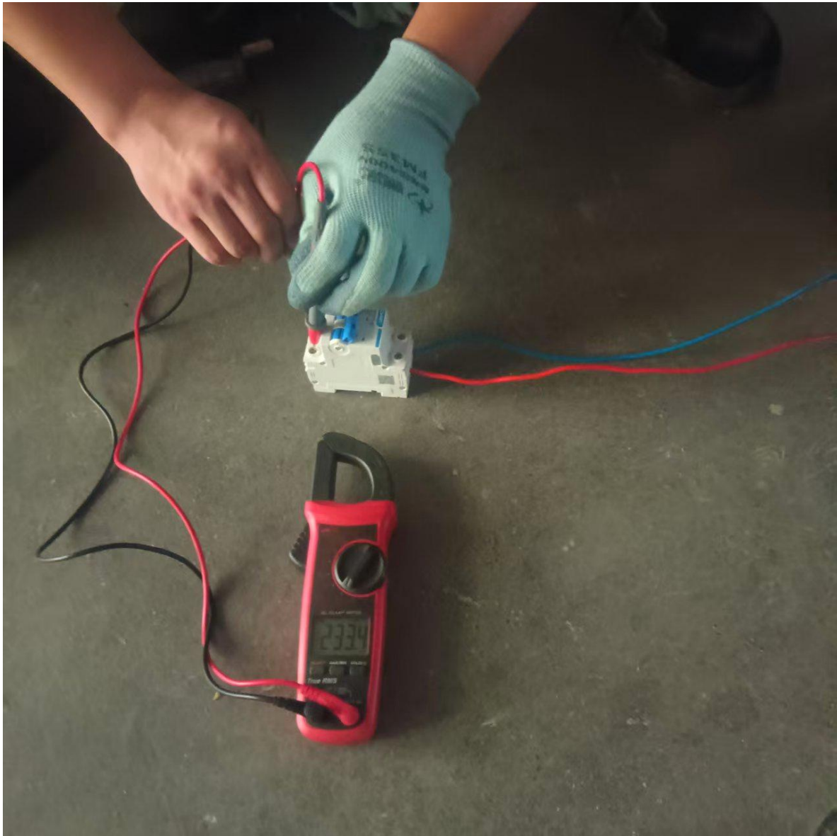
图3 经测事故线路电压 233.4v
